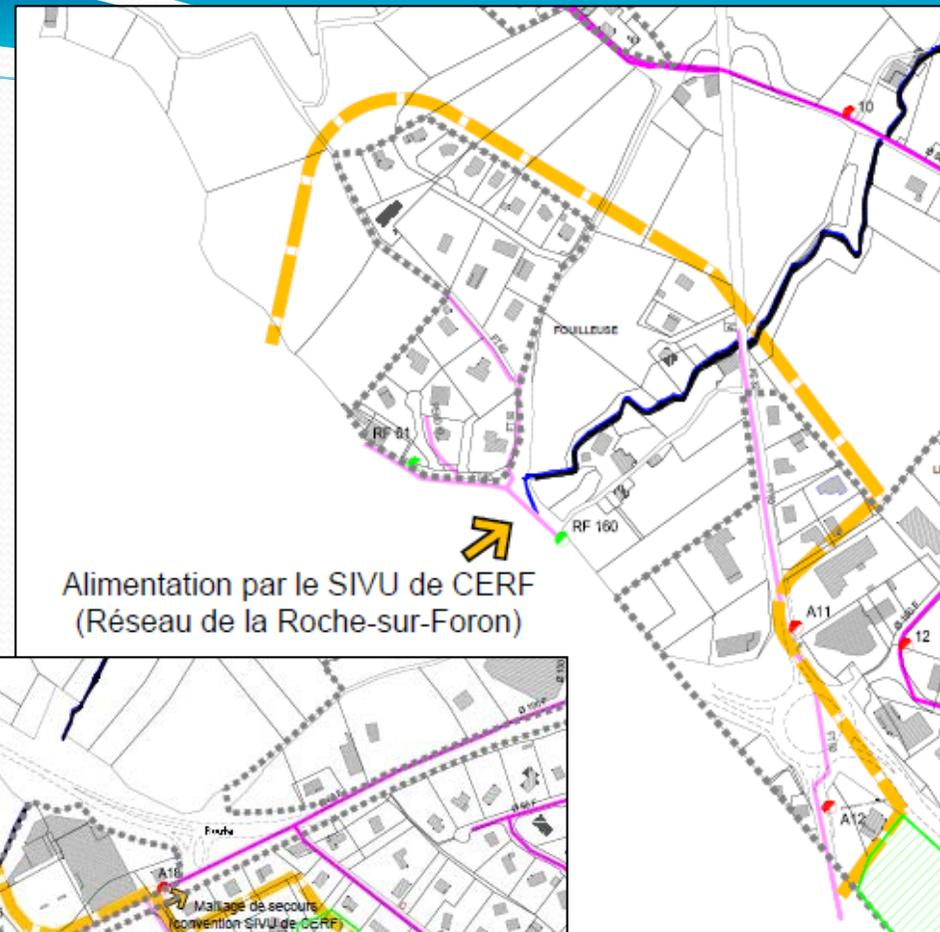
*Connexion + maillage de secours permettant d'alimenter une partie du réseau communal d'Amancy*
